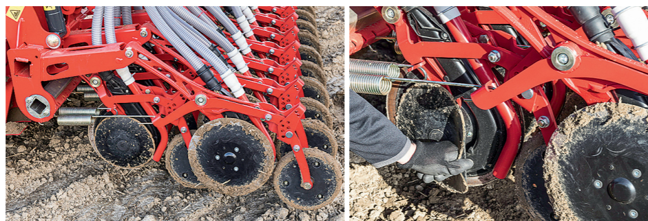
Nors abu produktai (sėklos) išberiami į tą pačią vagutę, jie išberiami arba pro juodą plastikinį sėklavamzdį (kairėje), arba pro raudoną plieninį sėklavamzdžio antgalį (dešinėje)
