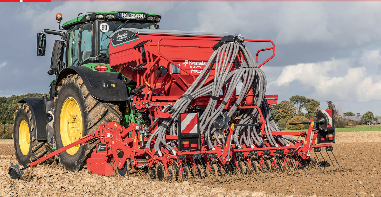
Pneumatinė sėjamoji E-Drill Maxi Plus turi dviejų dalių sėkladėžę ir du atskirus sėjamuosius aparatus – dozavimo įrenginius: idealus sprendimas ūkiams, norintiems su sėklomis įterpti ir trąšas arba ketinantiems sėti su įsėliu
